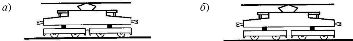
Рис.2.7. Односекційний кузов, прикріплений за допомогою опор до поворотних зчленованих візків (а); до незчленованих візків (б)
